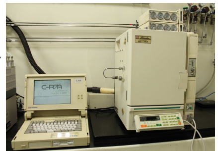
分析装置の外観：ガスクロマトグラフ
