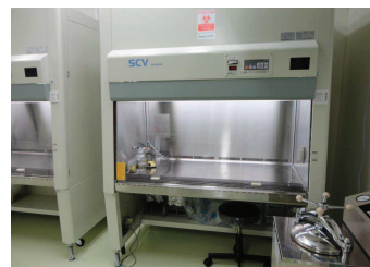
新設の安全キャビネットです。
