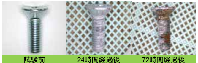
図.塩水噴霧試験経過写真
