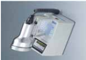
GM 計数管式サーベイメーター
